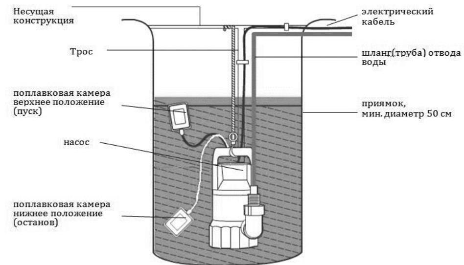
Подсоедините водоотводные трубы или шланги к выпускному отверстию через переходники (в комплект поставки не входят). Диаметр отводящей магистрали должен быть не меньше, чем диаметр входного отверстия.
